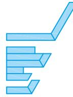
**Knauf Platte mit V-Fräsung 60°**
