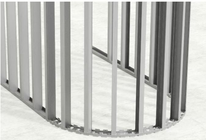
Unterkonstruktion mit Knauf Sinus-Profil.
